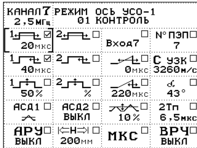
Рисунок ПА.21 – Вид экрана дефектоскопа. Канал 7, формат «А-ТАБЛИЧНЫЙ»
