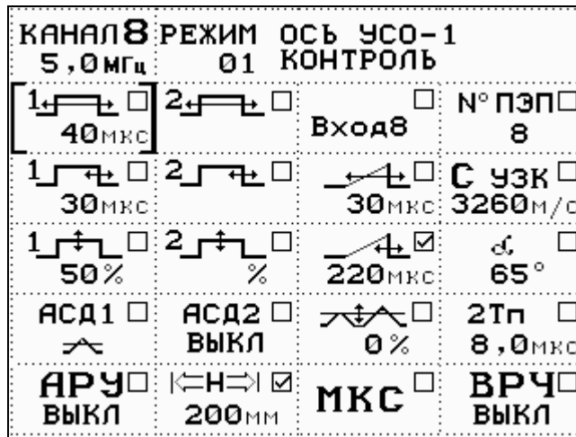
Рисунок ПА.24 – Вид экрана дефектоскопа. Канал 8, формат «А-ТАБЛИЧНЫЙ»
