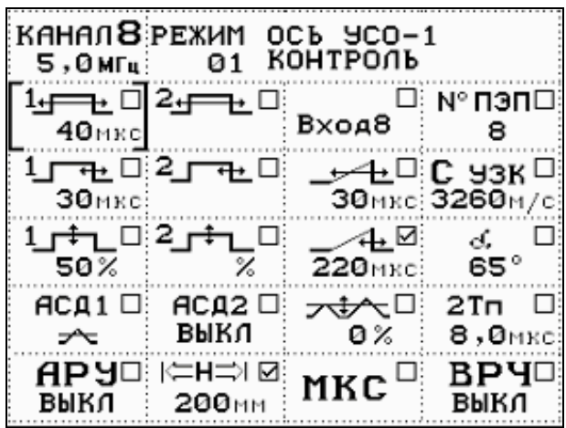
Рисунок ПА.26 – Вид экрана дефектоскопа. Канал 8, формат «А-ТАБЛИЧНЫЙ»
