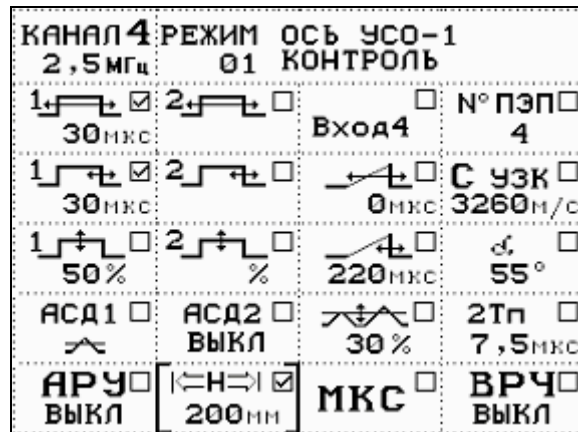
Рисунок ПА.10 – Вид экрана дефектоскопа. Канал 4, формат «А-ТАБЛИЧНЫЙ»
